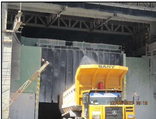
ภาพที่ 2.24 ระบบ Spray น้ำอัดโน้ตในกระบวนการบดย่อยหิน
