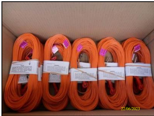
ภาพที่ 2.18 การใช้แถบหน่วงเวลาเพื่อควบคุมปริมาณวัตถุระเบิดต่อจังหวะการระเบิด ให้มีค่าน้อยกว่า 650 กิโลกรัม/จังหวะถ่วง
