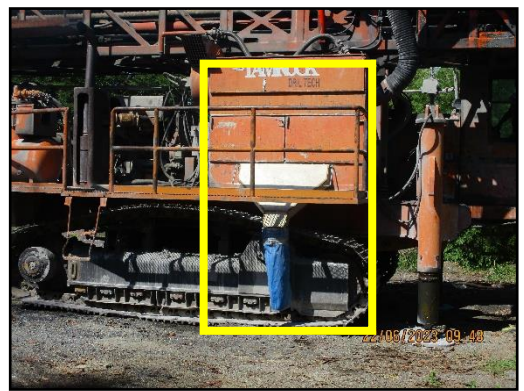
ภาพที่ 2.22 รถเจาะระเบิดที่ติดตั้งอุปกรณ์กำจัดฝุ่นที่ออกมาจากการเจาะระเบิด
