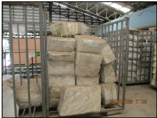
ภาพที่ 2.30 ถุงกรองสำหรับเครื่องดักฝุ่นแบบ Bag Filter
