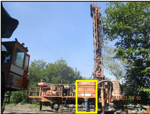
ภาพที่ 2.22 รถเจาะระเบิดที่ติดตั้งอุปกรณ์กำจัดฝุ่นที่ออกมาจากการเจาะระเบิด
