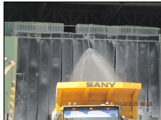
ภาพที่ 2.24 ระบบ Spray น้ำอัดโน้ตในกระบวนการบดย่อยหิน
